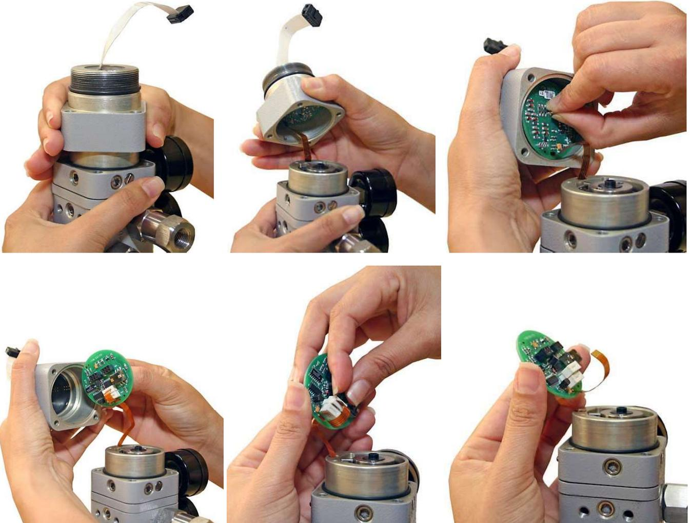
**Figura 08 - Desmontagem da Tampa de Ligação e Placa Analógica**
